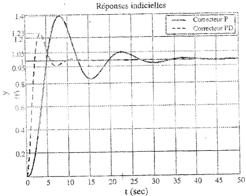
Figure C.3 : Réponses indicielles unitaires en boucle fermée.
